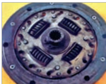
شکل ۲۷-۱- نمونه صفحه کلاچ معیوب
