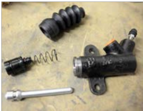
شکل ۲۴-۱- اجزای سیلندر اصلی کلاچ
