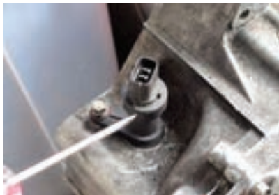
شکل ۲-۲۴- روش تعویض میکروسوییچ دنده عقب و حسگر سرعت
