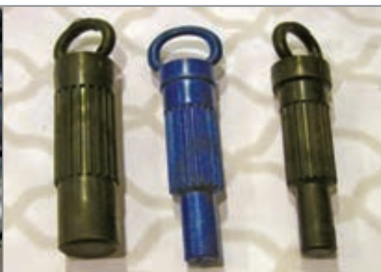
شکل ۱-۳۶- نمونه‌هایی از ابزار هم‌محور کننده صفحه کلاچ
