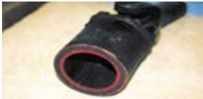
شکل ۱۱-۳- مقطع گاردان دو لایه با لایه لاستیک میانی
