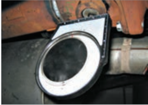
شکل ۱۳-۳ روش استفاده از زاویه سنج میل گاردان
