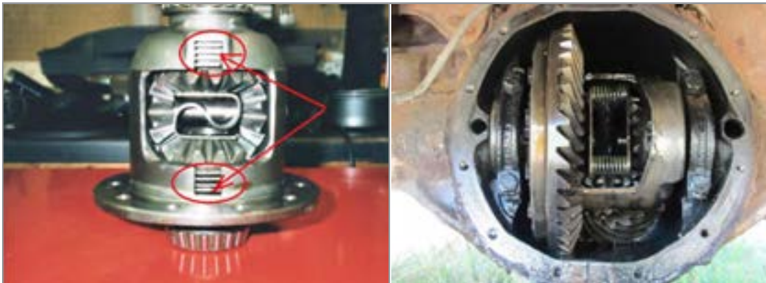
شکل ۷-۴- هوزینگ دیفرانسیل ضد لغزش و فنرها
