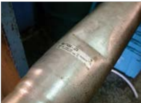
شکل ۱۵-۳ مشاهده آثار ضربه روی سطح میل گاردان
