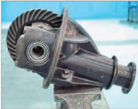
شکل ۴-۲۸- بستن مجموعه دیفرانسیل روی گیره
