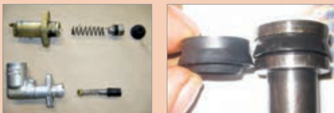
شکل ۲۱-۱- الف) نشتی داخلی در مدار هیدرولیکی
