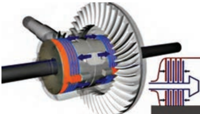
شکل ۶-۴- عملکرد دیفرانسیل ضد لغزش
