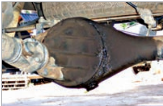
شکل ۱۵-۴- نقاط احتمالی نشتی در دیفرانسیل محرک عقب
