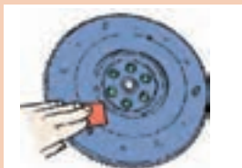
شکل ۱-۳۲- نحوه برطرف نمودن عیوب جزئی سطح فلائیویل
