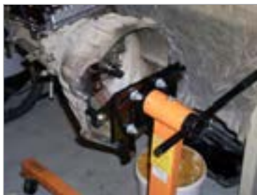
شکل ۲۸-۲ انواع استند تعمیراتی جعبه‌دنده و نحوه نصب آن
