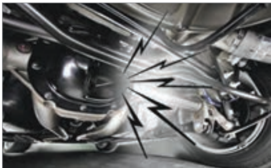
شکل ۹-۴- علل شنیدن صدای غیر عادی دیفرانسیل
