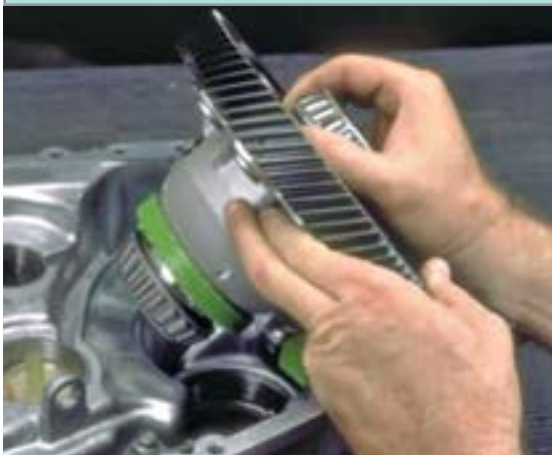
تفکیک اجزای مجموعه جعبه دنده از روی محورها با کمک پرس و ابزار مخصوص
