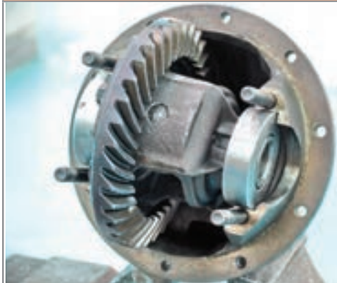
شکل ۴-۶۰- استفاده از رولبرینگ آزمایشی
