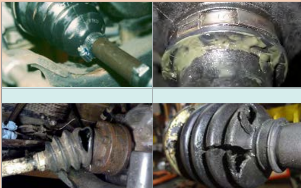
شکل ۱۷-۵- روش بررسی ظاهری پلوس‌ها
