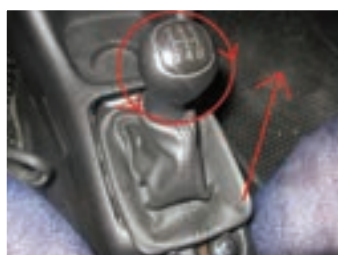
شکل ۲-۲۳- تعویض گردگیر دسته دنده
