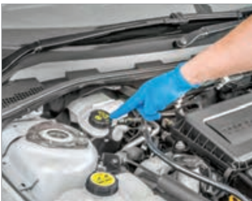
شکل ۱۶-۱- مخزن مایع مشترک در یک خودرو
