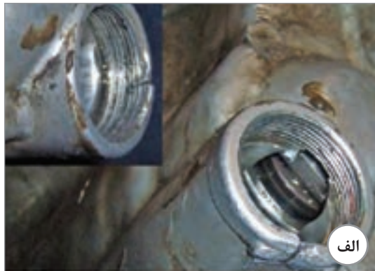
شکل ۳۲-۲- پوسته جعبه دنده و نحوه ترمیم آن
