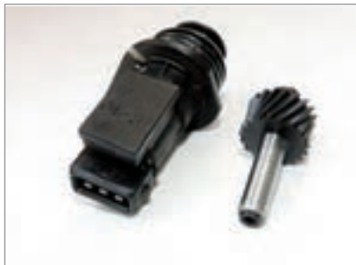
شکل ۲۰-۲ حسگر سرعت خودرو روی جعبه دنده
