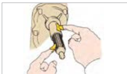
شکل ۱-۳۵- نحوه گریس کاری شفت کلاچ
