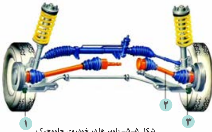
شکل ۵-۵- پلوس‌ها در خودروی جلو محرک
