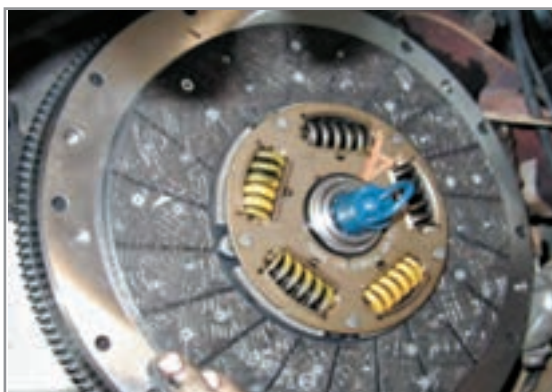
شکل ۱-۳۷- نحوه قرارگیری شفت هم‌محور کننده صفحه کلاچ
