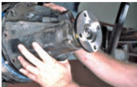
شکل ۲۵-۴- باز کردن مجموعه دیفرانسیل
