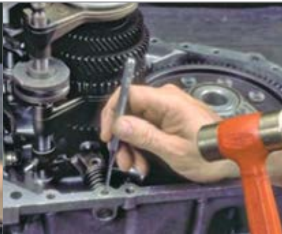
خارج کردن پین نگهدارنده اهرم تعویض دنده
