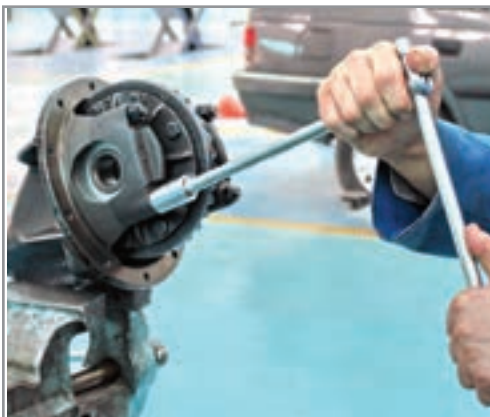
شکل ۶۱-۴- بستن کپه یاتاقان‌ها
