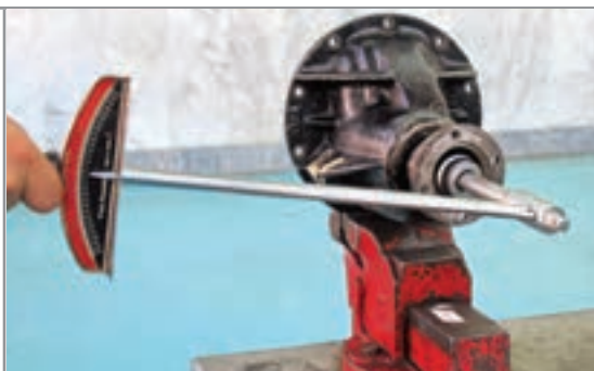
شکل ب ۵۶-۴- تعیین گشتاور پیش بار با گشتاورسنج
