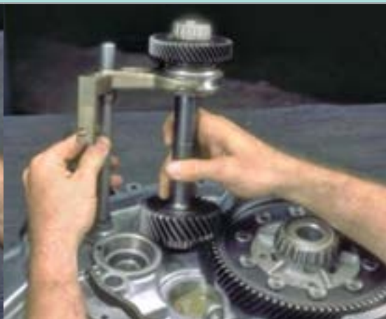
تفکیک اجزای مجموعه جعبه دنده از روی محورها با کمک پرس و ابزار مخصوص
