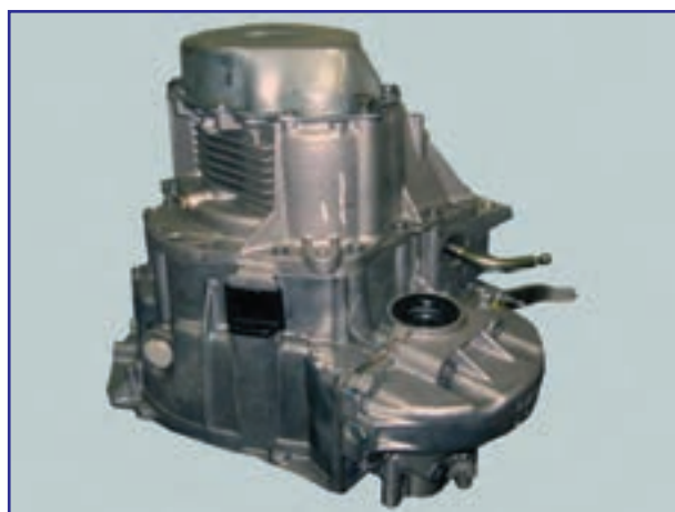
شکل ۳-۱- گیربکس دستی (BE4)
