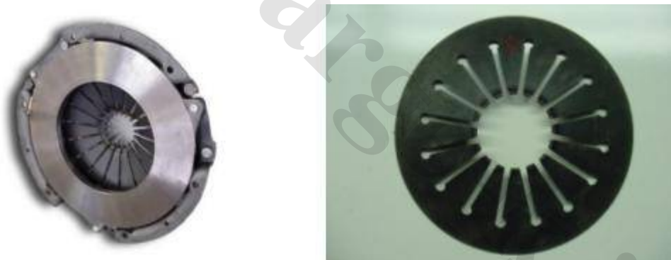
فنر دیافراگمی و نمونه ای از کلاچ دیافراگمی
